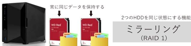
簡単に言うと「壊れた時のスペア」を作る機能です。「冗長化」ともいいます。一般的に複数のHDDを積む理由は容量を増やすためか、速度を上げるRAID 0(ストライピング)のためですが、企業用NASは基本的にこのミラーリング機能を搭載しています。
